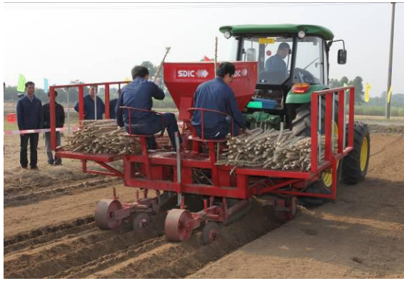
图 19 木薯种植机，左：同步种植施肥 右：起垄前已施肥
