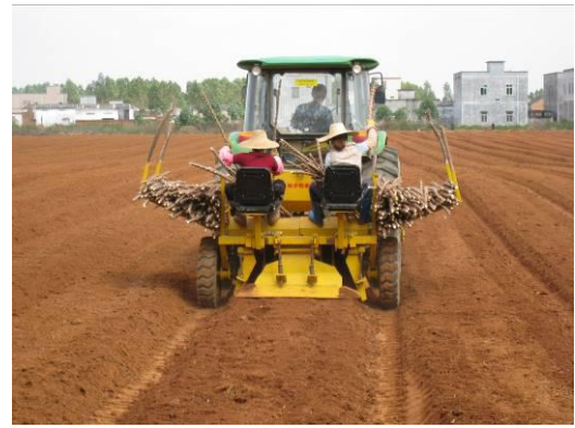
图 19 木薯种植机，左：同步种植施肥 右：起垄前已施肥
