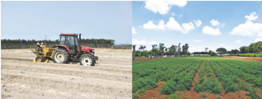
图 16 2CM-2 垄作式木薯联合种植机与木薯生长效果
