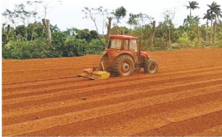
图 15 1GL-180 型木薯旋耕起垄机及垄形效果
