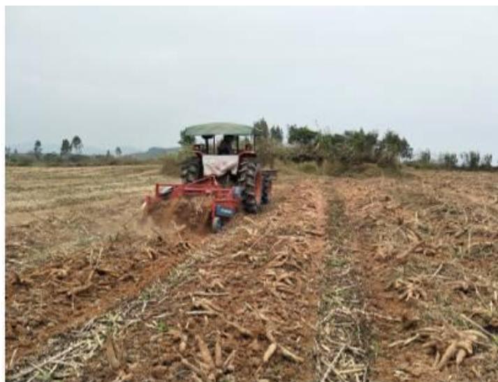
图 8 改进型振动链式木薯挖掘收获机作业现场
